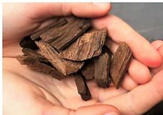
Dos muestras de astillas tras pasar por la planta de torrefacción donde se extraen con humedad cero. // FOTOS: A. PÉREZ
