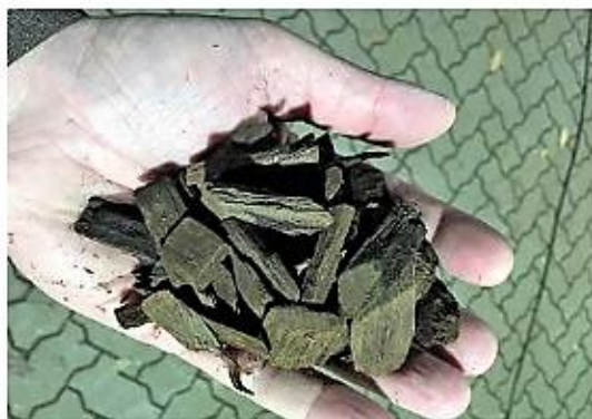
Dos muestras de astillas tras pasar por la planta de torrefacción donde se extraen con humedad cero. // FOTOS: A. PÉREZ
